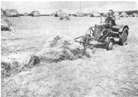
Kleinschlepper mit Frontlader in der Heuernte beim Zusammenschwaden und Laden von Heu
